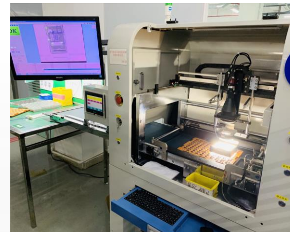
镭雕字符视觉检测自动设备
